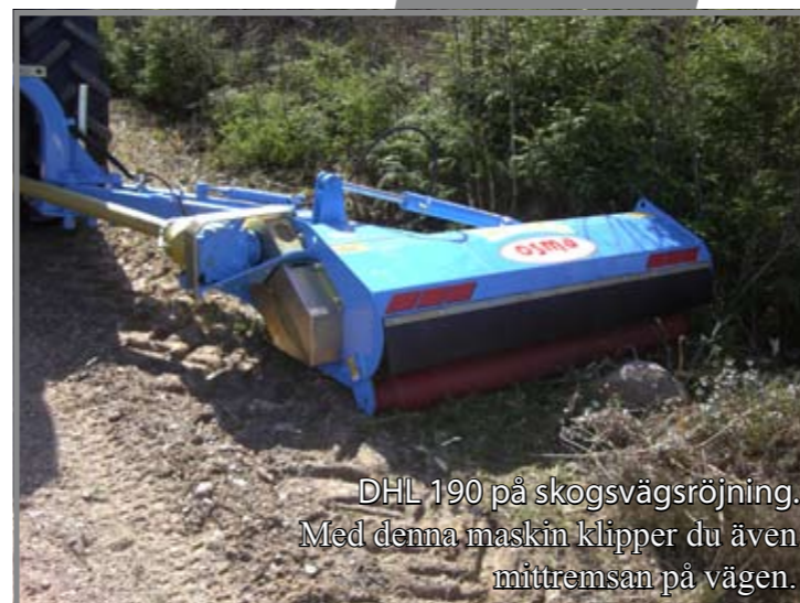
Klipper allt som viker sig framför maskinen (max 10cm) med hammar slagan. Demo-film på hemsidan.
