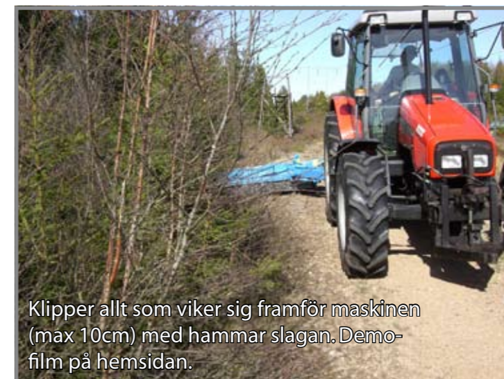
DHL 190 på skogsvägröjning. Med denna maskin klipper du även mittremsan på vägen.
